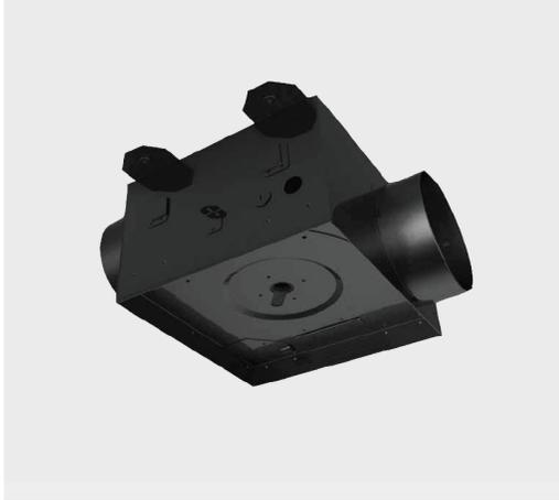
Los ventiladores de extracción para secadoras aseguran un funcionamiento eficiente y confiable, debido al diseño de estos. Estos cuentan con dos soportes fijos con orificios para una fácil instalación, para su correcto montaje se deben colocar aislantes de goma al instalarlos. Impulsor con bisagras para facilitar la limpieza y el mantenimiento. Rodete de alabes inclinados hacia atrás para un funcionamiento suave y silencioso.
